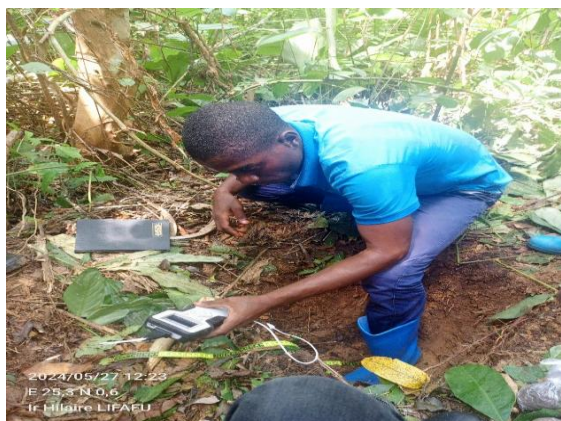
Figure 3. Collecte des données sur terrain à l'aide de l'appareil TEMPOS meter (Photo crédit : Lifafu).
