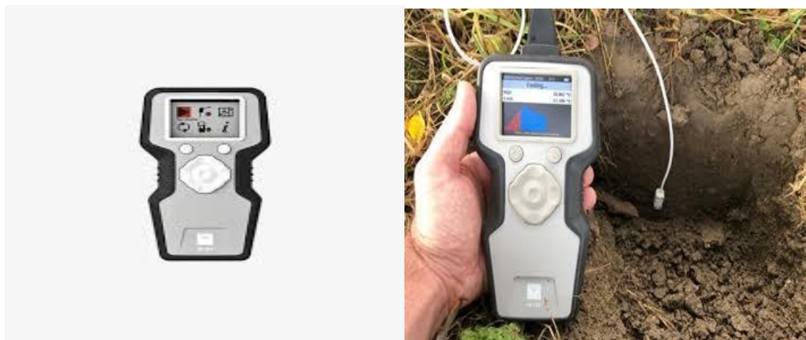
Figure 2. Appareil tempos meter Analyzer thermique sans le câble d'aiguilles de capteur (gauche) et avec le câble d'aiguilles de capteur (droite)
